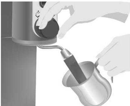
6. Öffnen Sie den „☁“ Dampfdruckregler langsam durch Drehen entgegen dem Uhrzeigersinn. Je weiter Sie den „☁“ Dampfdruckregler nach links drehen, umso größer ist die austretende Dampfmenge. Halten Sie den Krug schräg, um eine Wirbelbewegung der Milch zu erhalten und halten dabei die Spitze der Aufschäumdüse ungefähr 5 mm unter die Milchoberfläche. Entstehen große Blasen oder die Milch spritzt heraus, halten Sie die Düse zu hoch.
