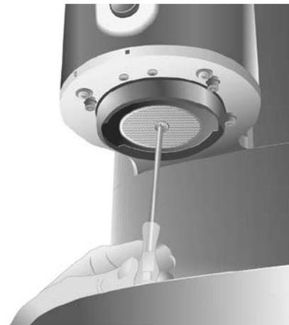
3. Setzen Sie das Spülsieb mit der glatten Seite nach unten in den Brühkopf ein und befestigen es mit der Siebmutter. Drehen Sie die Schraube bis zum Anschlag im Uhrzeigersinn ein, bis das Sieb einrastet.
