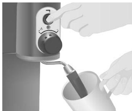
**HINWEIS:** Vor dem Wasser kann noch eine gewisse Menge Restdampf aus der Düse austreten. Es kann einige Sekunden dauern, bis Wasser aus der Düse austritt.
