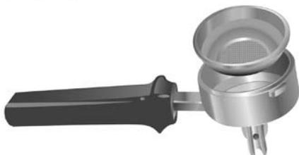
4. Setzen Sie den Siebträger unter den Brühkopf und richten den Griff des Siebträgers mit der „▽“ Markierung auf der linken Seite des Metallzierrings aus. Heben Sie den Siebträger in den Brühkopf und drehen dann den Griff des Siebeinsatzes im Uhrzeigersinn bis zur „■“ Markierung auf dem Metallzierring.
