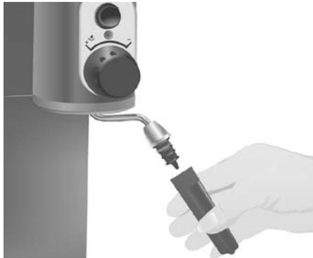
2. Wischen Sie das Dampfrohr und die Düse mit einem sauberen, feuchten Tuch ab. Benutzen Sie keine Scheuerschwämme.
