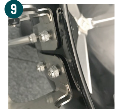
9 Hier können Sie die losen Bolzen sehen: Das Scharnier kann leicht nach unten und oben entlang der Schlitzes bewegt werden.
